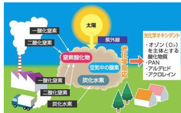
光化学汚染の発生のしくみ
