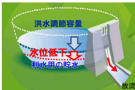
◎現状で、多目的ダムは、洪水期(夏～秋)に洪水調節容量を確保します。利水ダムは、年間通して洪水調節容量を持ちません。
