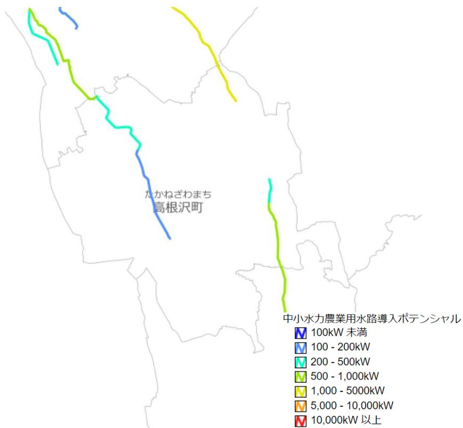
図 5-3 中小水力発電の導入ポテンシャルマップ
